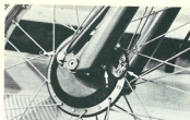
Fig. 23 A) Vite scarico olio B) Leva freno C) Vite fiss. asta di fermo freno
