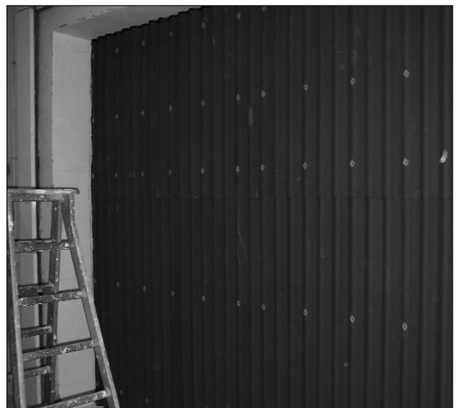
Figura 3 - Esempio di montaggio in verticale di un elemento di copertura all'interno del laboratorio
