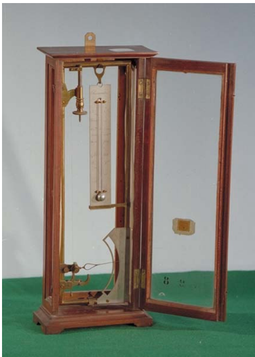
Figura 16 : Gli igrometri a capello si possono considerare tutti derivati da quello ideato da Horace-Bénédict de Saussure, naturalista e fisico svizzero, vissuto nel XVIII secolo. In questo esemplare l'igrometro è all'interno di un armadietto di legno, munito di anta con vetro, nel quale è alloggiato anche un termometro a mercurio con scala da -20\text{ }^{\circ}\text{C} a +35\text{ }^{\circ}\text{C} . L'apparecchio può essere sospeso al muro per mezzo di un gancetto.
