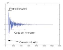
L'effetto delle riflessioni può essere graficamente riportato tramite un diagramma che riporta il suono in dB in funzione del tempo.
