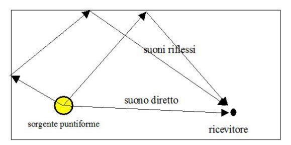
L'energia riflessa dalle superfici di confine dipende dai coefficienti di assorbimento, di riflessione e di trasmissione.
