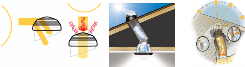
Fig.13 – Funzionamento solar tube
